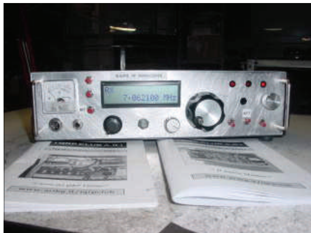
RX 20/40 mt Singola conversione con DDS di Ik3UMZ
